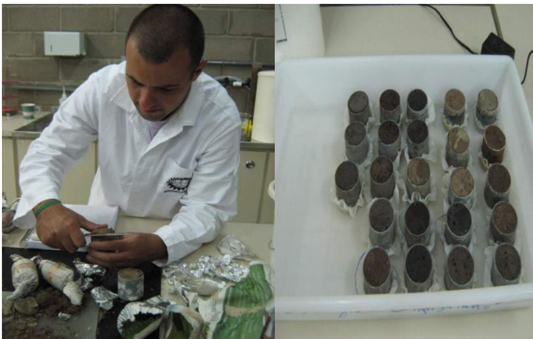
Figura 7 – Anéis em fase de acabamento para posteriormente serem saturados
