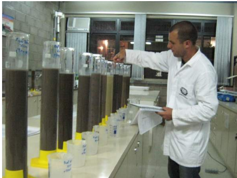
Figura 8 – Determinação das frações texturais pelo método do Densímetro de Bouyoucos
