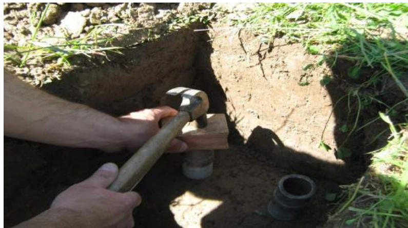
Figura 6 – Coleta de amostras com anel volumétrico na camada intermediária
